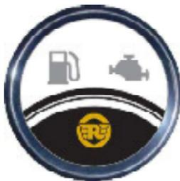
Ce compteur comporte deux indicateurs : du niveau de carburant et d'anomalie.
